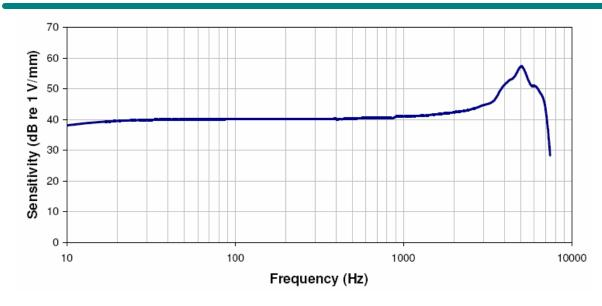
上图描述的是传感器的底部被固定,橡胶垫的顶面与被测物体接触,检测活塞式位移运动的频率响应曲线。
